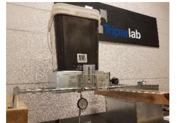
Barres de suspension 1287 sur plafond suspendu 24"
