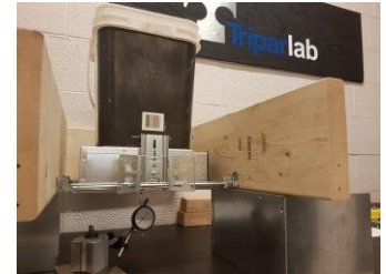
Barres de suspension 1287 sur Solives en bois 16"
